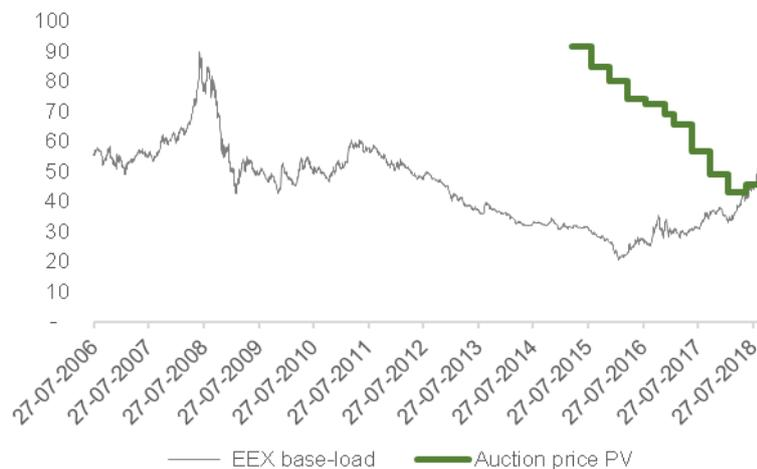
EEX-Strompreise und durchschnittliche Zuschläge im FFAV in EUR / MWh
